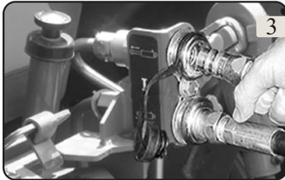
Para operar con el RAL 2000 con tren rodante, conectar las mangueras de los cilindros hidráulicos al tractor.
