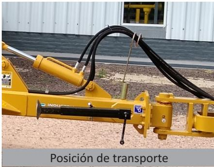
Retirar el perno del enganche que se vincula con la barra de tiro de la pala hidráulica para poder separar los dos equipos.
