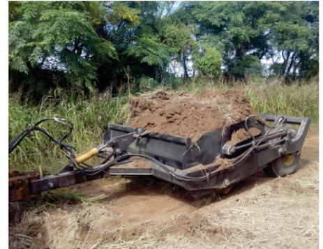
Una vez que los equipos se encuentren en el terreno a trabajar controlar los movimientos de la pala desde la cabina del tractor accionando los cilindros hidráulicos. Regular Profundidad de corte y altura del chasis utilizando los cilindros correspondientes.
